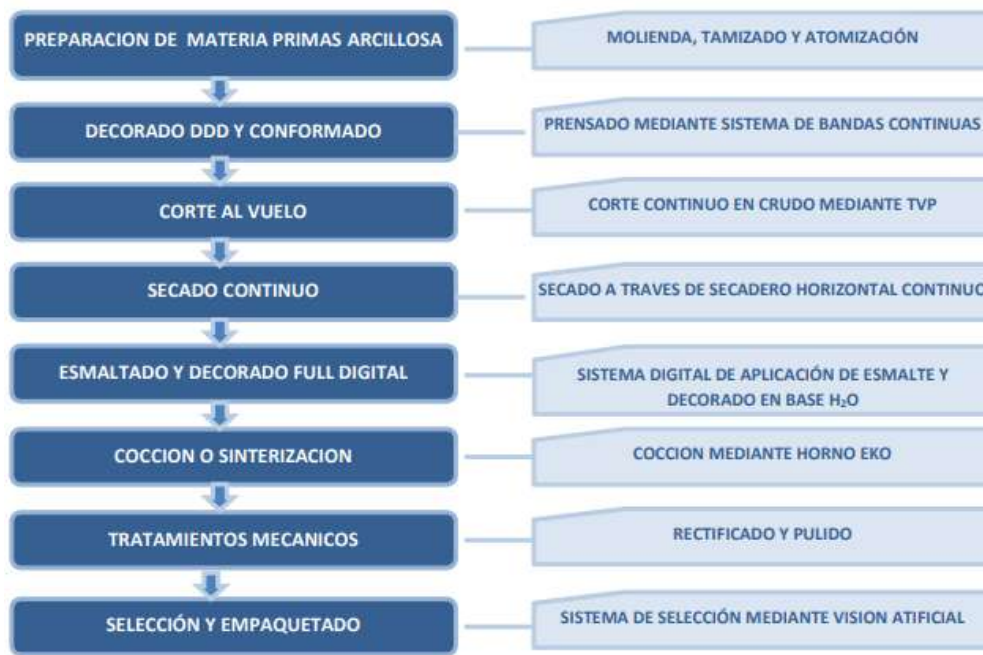
Figura 3: Esquema de flujo simplificado del proceso productivo de las superficies MDi
